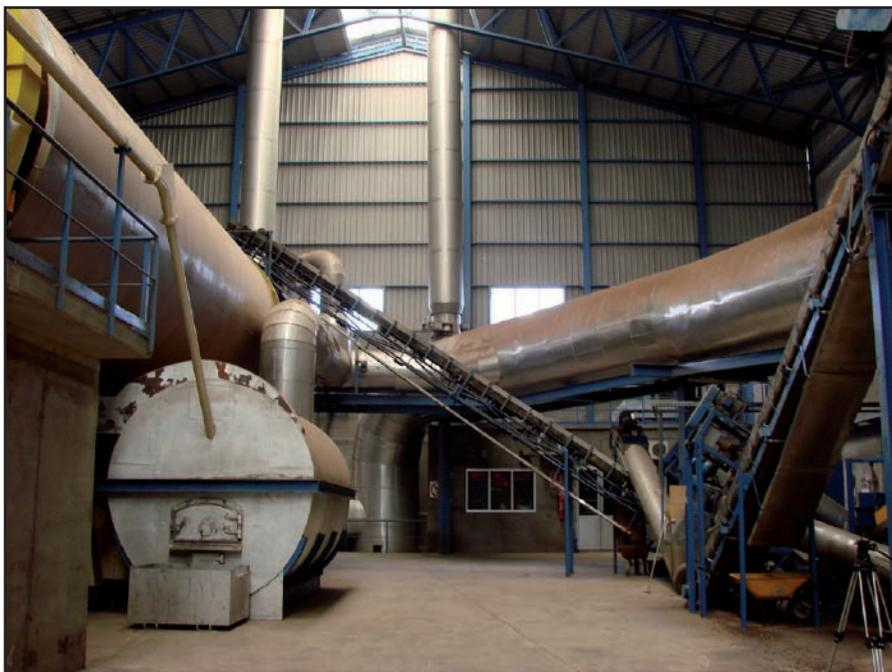
Hornilla de biomasa para la producción de gases para los secaderos.
