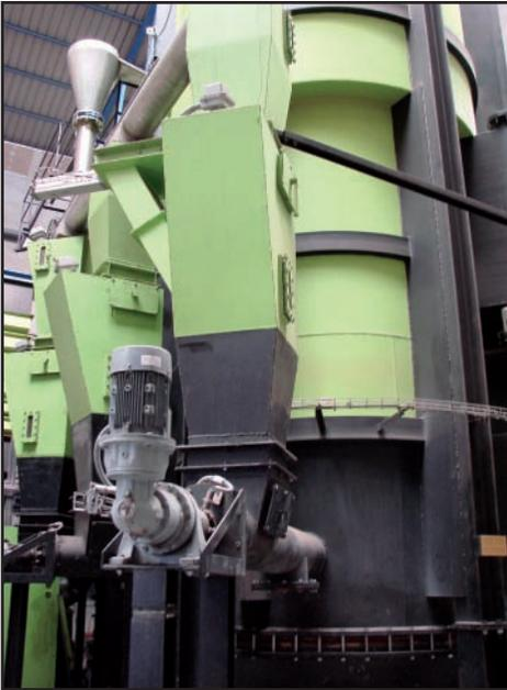
Vista de dos de las bocas del sistema de alimentación del gasificador.
