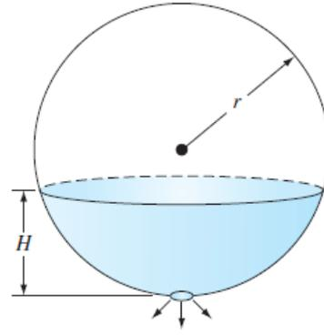
Donde  $Q_{sal}$  es el flujo de salida (m<sup>3</sup>/s), C es un coeficiente obtenido en forma empírica, A es el área del orificio (m<sup>2</sup>), g es la constante gravitacional y H es la profundidad del líquido dentro del tanque. Determine cuántos minutos tomaría que el agua fluyera por completo de un tanque de 1 m de diámetro con altura inicial de 0.75 m. Observe que el orificio tiene un diámetro de 3 cm y C = 0.55.
