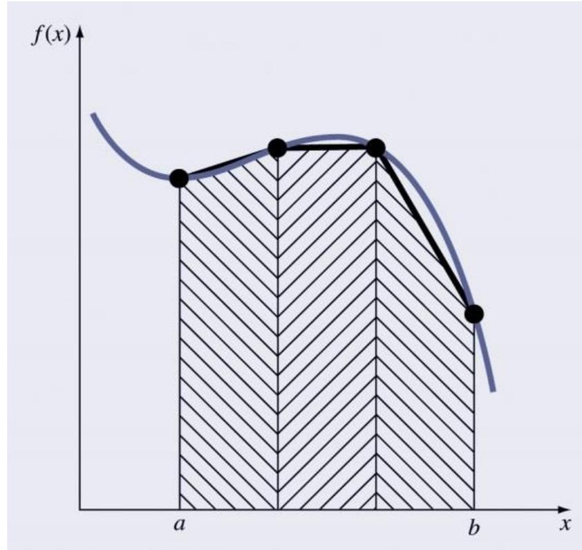
Aproximación de una integral mediante el área bajo tres segmentos de recta.
