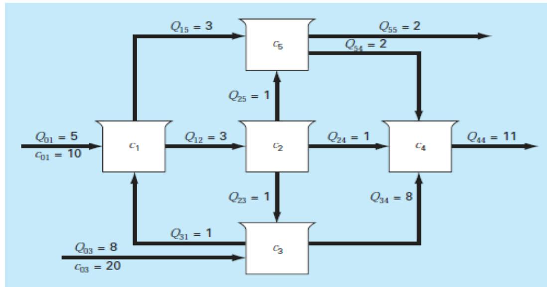
con dos tubos de entrada y dos tubos de salida donde los caudales  $Q$  están en metros cúbicos por minuto, y las concentraciones  $c$  están en miligramos por metro cúbico. Realizar un balance de materia suponiendo mezcla perfecta y que los reactores operan en estado estacionario.
