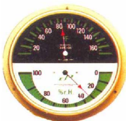
Figura 4: Psicrómetro de pared que indica HRA y temperatura de bulbo seco
