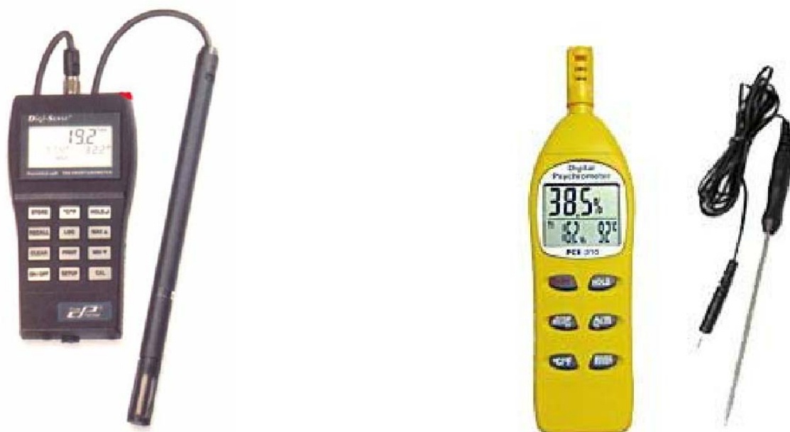
Figura 5: Psicrómetros que indican y almacenan datos de temperatura de bulbo húmedo, temperatura de rocío y HRA
