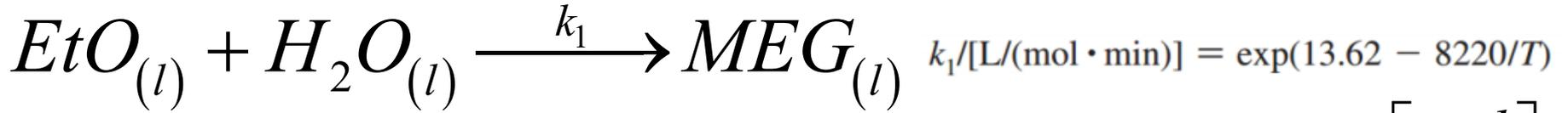
$$(-r_{EtO}) = k_1 C_{EtO} C_{H_2O} \quad k_1 \left[ \begin{matrix} \text{?} \\ \text{?} \end{matrix} \right] \quad C_{EtO}; C_{H_2O} \left[ \frac{mol}{m^3} \right]$$
