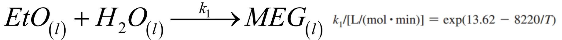
$$(-r_{EtO}) = k_1 C_{EtO} C_{H_2O} \quad k_1 = A_1 e^{-\frac{E_1}{RT}}$$
