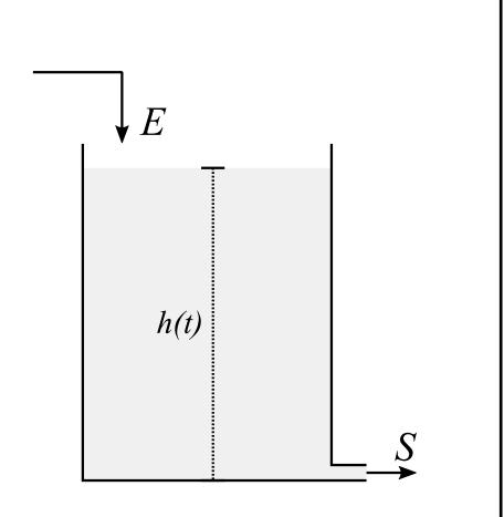
• Balance de materia en el tanque: Acumulación = Entrada – Salida
