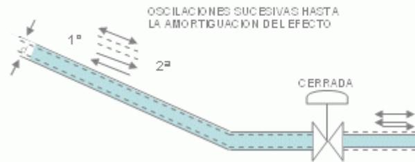
El golpe de ariete se produce en las tuberías cuando se realizan operaciones rápidas en los equipos que abren, cierran, o regulan el deslizamiento del agua, como ser válvulas, compuertas, anclajes, etc. Este fenómeno también puede darse cuando existen reducciones bruscas de la potencia requerido a un generador accionado por turbina hidráulica.
