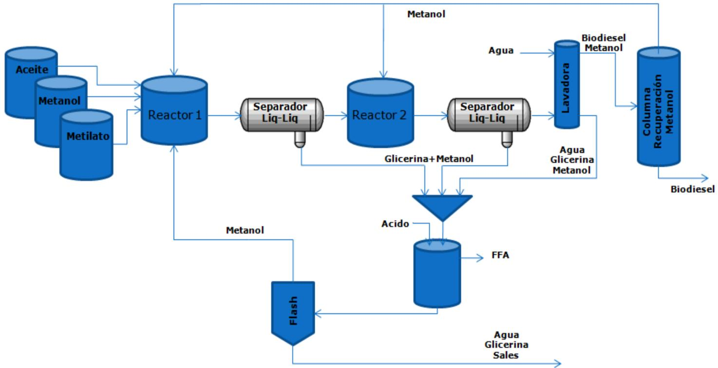
Fig. 1. Diagrama de flujo del proceso de producción de biodiesel.
