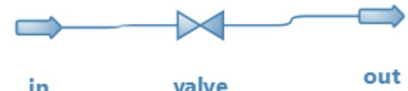
Se deben conectar una corriente de entrada y una de salida.
